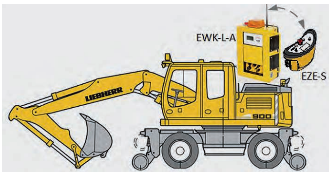
Abb. 5: Zweiwegebagger im Einsatz mit angehängter Warngruppe
